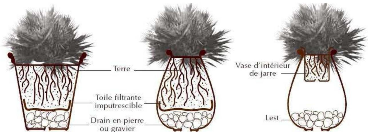
Le drainage permet l'écoulement de l'eau, ce qui diminue fortement le risque de gel pour la plante et pour le pot
